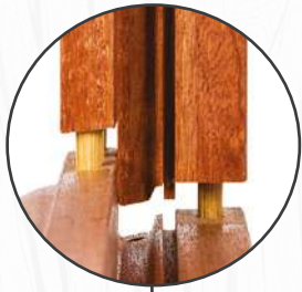
Assemblage des dormants et ouvrants en contre-profil et tourillons collés.
