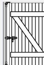
Panneau en lame PVC 24 mm épaisseur 2,1mm -Profil U de cadre 24 x 12 en PVC -Battement central moulurée -Pentures aluminium festonnées -Profil de barre moulurée lg 80mm -Profil écharpe moulurée 80mm -Espagnolette ronde -Gonds chimique et Arrêts à visser
