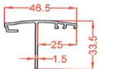
Couvre joint aluminium avec joint d'étanchéité
