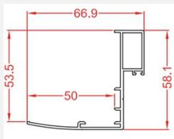
Précadre de 50mm en aluminium 3 cotés pour les gammes Lim tendance, Lim colors, Lim extrudé et Lim PVC
