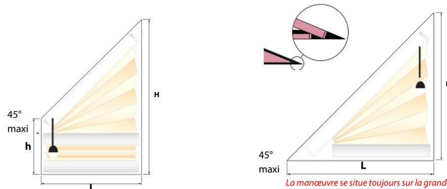
La manœuvre se situe toujours sur la petite hauteur. Nous préciser le sens de pose du store vu de l'intérieur. Prendre côtes de la superficie à couvrir.
