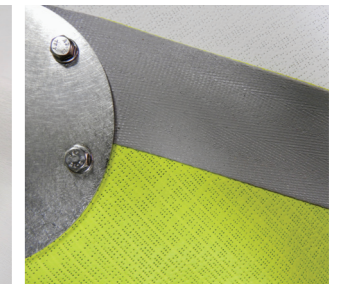
Bande de renfort grise soudée en périphérie
