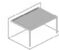
Adossée lame perpendiculaire au mur On facade Louvers perpendicular to the wall
